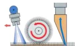
**Charis-ONE** est une machine compacte, pour le nettoyage des surfaces moyennes. Avec Charis-ONE il est possible de nettoyer parfaitement une bande de 40 cm de moquette, en enlevant la saleté jusqu'au cœur des fibres. La quantité d'eau injectée peut être réglée, pour effectuer un **nettoyage d'entretien** à humidité faible, **ou bien un nettoyage de remise en état**.
