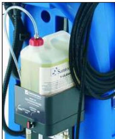
SMARTKIT permet de réaliser **le dosage automatique du détergent**, en assurant une concentration correcte de produit chimique, en éliminant toute opération de dilution normalement nécessaires à l'opérateur.
